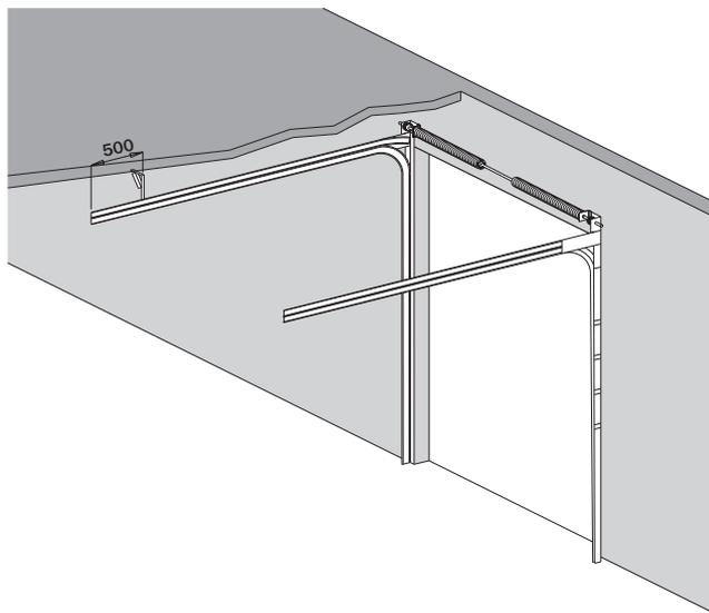
**CZ** Od plochy otvoru 12m<sup>2</sup> je potřeba dvou horizontálních ukotvení u každé kolejnice.
